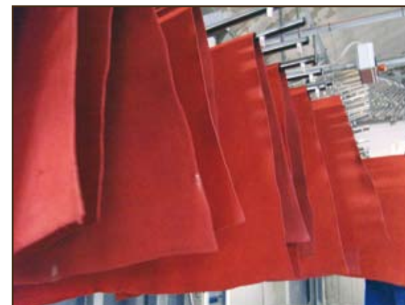
4. pelli sulla catena per l'asciugaggio - leathers loaded on aerial chain for naturally dried in the air
